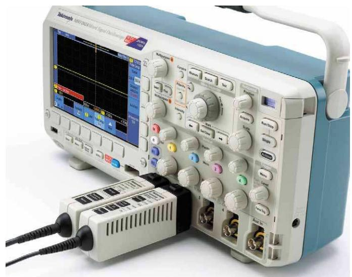
Интерфейс TekVPI упрощает подключение пробников к осциллографу.
