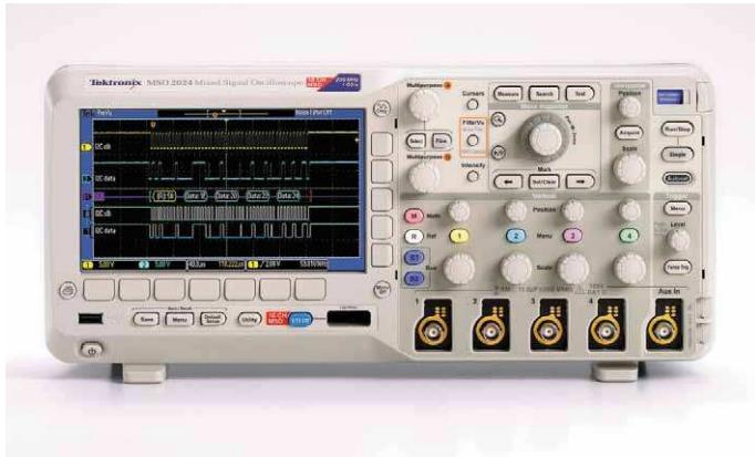
Осциллографы серии MSO/DPO2000 созданы для того, чтобы облегчить вашу работу. Яркий широкоэкранный дисплей отображает фрагменты сигнала большой протяжённости. Специальные органы управления на передней панели упрощают работу. Порт USB на передней панели позволяет сохранять снимки экрана, настройки прибора и осциллограммы на внешних носителях.
