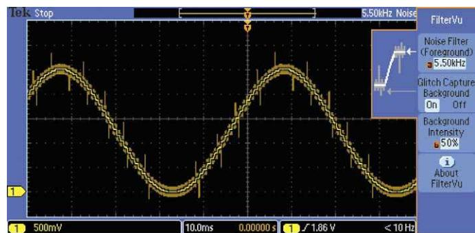
Выходной сигнал с цифро-аналогового преобразователя. Обратите внимание, как функция FilterVu™ четко отображает незашумленные ступеньки сигнала ЦАП, подавляя все частоты выше 5,5 кГц (осциллограмма на переднем плане, желтая). Вместе с тем, FilterVu позволяет захватывать и отображать высокочастотные глитчи во всей полосе пропускания осциллографа (фоновая осциллограмма, оранжевая).
