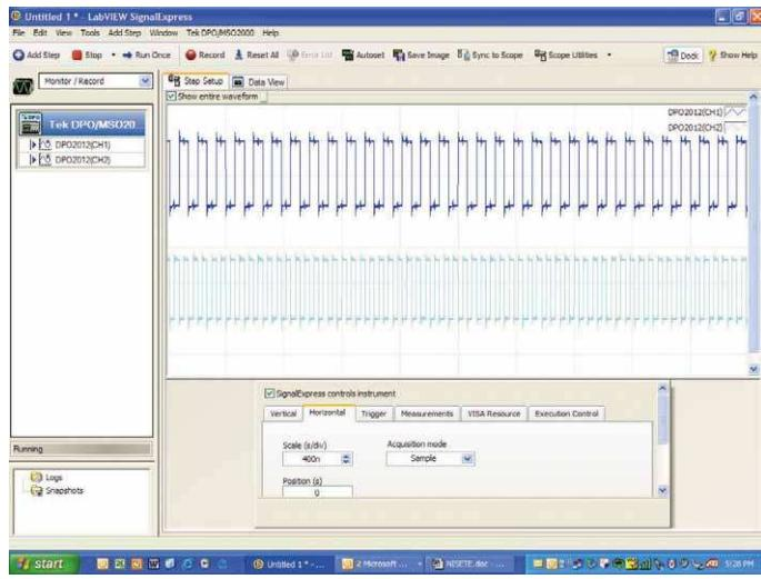
NI LabVIEW SignalExpress™ Tektronix Edition — это полностью интерактивное программное обеспечение для измерения и анализа захваченных сигналов, разработанное совместно с компанией National Instruments и оптимизированное для осциллографов серий MSO/DPO.
