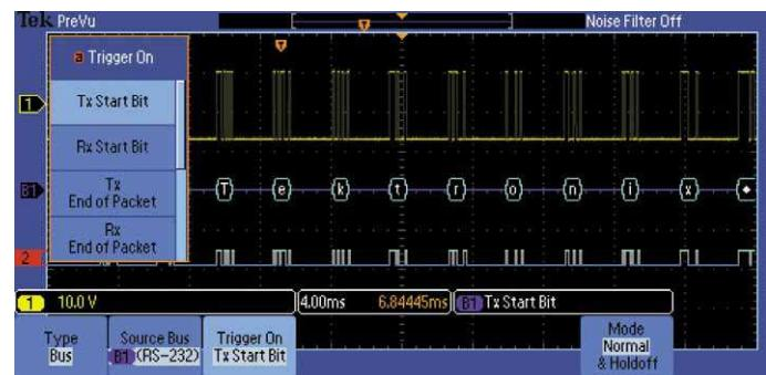
**Захват** — Запуск по определённому пакету данных, передаваемому по шине RS-232. Полный набор функций запуска, включая запуск по содержимому пакета последовательных данных, гарантирует быстрый захват представляющего интерес события.
