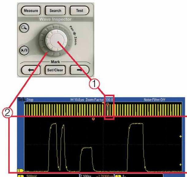
Панель управления Wave Inspector обеспечивает непревзойденную эффективность просмотра, навигации и анализа данных. Поворотом внешней ручки панорамирования можно быстро просмотреть всю запись длиной 1 млн. точек (1). Перемещение из начала в конец займет считанные секунды. Заметили что-то интересное и хотите рассмотреть подробнее? Просто поверните внутреннюю ручку масштабирования (2).
