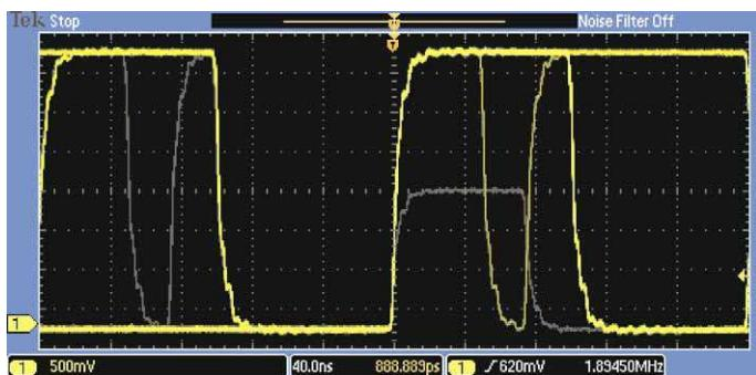
**Обнаружение** — Скорость захвата сигнала на уровне 5 000 осциллографм в секунду максимально повышает вероятность обнаружения кратковременных глитчей и других редко происходящих событий.
