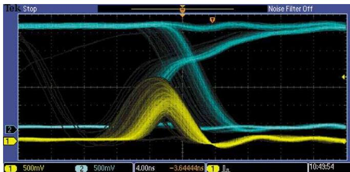
Технология цифрового люминофора в осциллографах MSO/DPO2000 обеспечивает скорость захвата 5 000 осциллограмм в секунду и отображение сигналов с градацией яркости в реальном времени.
