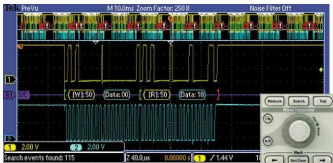
**Поиск** — Декодирование данных шины I<sup>2</sup>C с отображением результатов поиска адреса 50. Панель управления Wave Inspector обеспечивает непревзойденную эффективность при навигации и просмотре данных.
