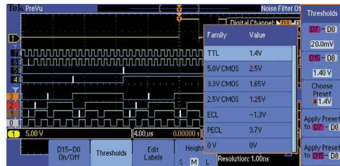
Отображение осциллограмм цифровых сигналов с цветовым кодированием позволяет объединять цифровые каналы в группы путем простого размещения их на экране рядом друг с другом. В результате эти цифровые каналы можно перемещать единой группой. Для каждой группы из восьми каналов можно установить свои пороговые значения, что обеспечивает поддержку логических устройств двух разных типов.
