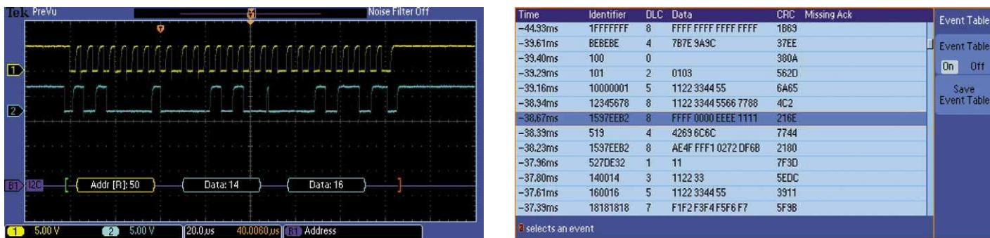
Запуск по определённому пакету данных, передаваемому по шине I<sup>2</sup>C. Желтая осциллограмма представляет собой сигнал тактовой частоты, а синяя — данные. Осциллограмма сигнала шины показывает декодированное содержимое пакета, включая Старт, Адрес, Чтение/Запись, Данные и Стоп.
