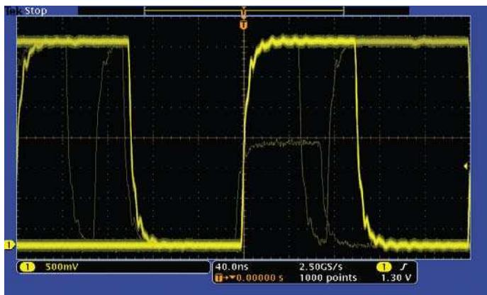
Обнаружение: высокая скорость захвата сигнала – более 50 000 осциллографов в секунду – максимально повышает вероятность обнаружения кратковременных глитчей и других редко происходящих событий
