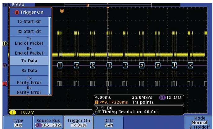
Захват: запуск по конкретному пакету данных, передаваемому по шине RS-232. Полный набор функций запуска, включая запуск по содержимому пакета последовательных данных, позволяет быстро захватывать интересующее событие.
