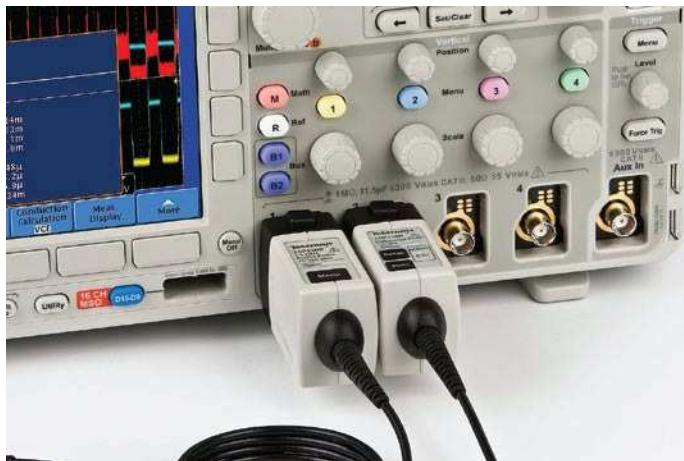
Интерфейс TekVPI упрощает подключение пробников к осциллографу.
