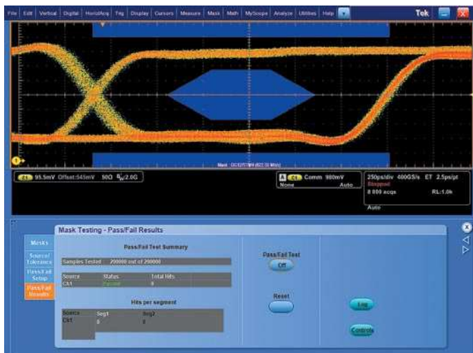
Тестирование сигнала OC-12 при помощи маски, захват всех нарушений маски.
