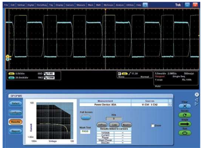
Измерение безопасной рабочей зоны. Автоматический анализ источников питания позволяет быстро и точно выполнять анализ типовых параметров.
