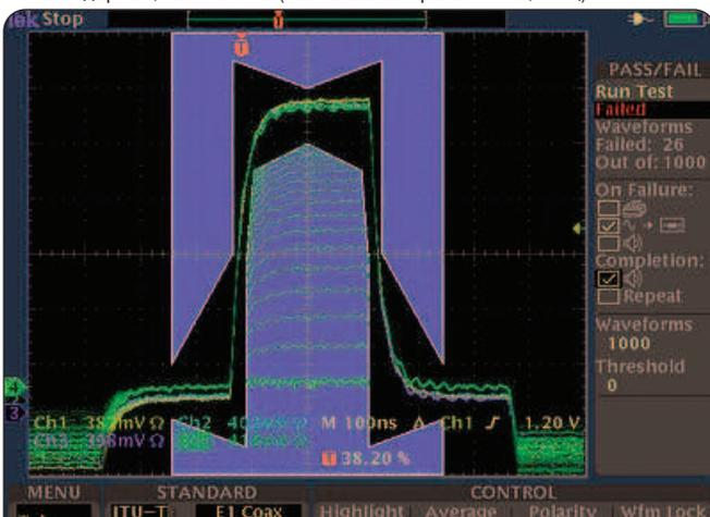
► Осциллограф с цифровым люминофором серии TDS3000C обеспечивает существенное увеличение скорости тестирования для линий телесвязи. Благодаря QUICKMENU все часто используемые функции тестирования телекоммуникационного оборудования располагаются в одном меню.
