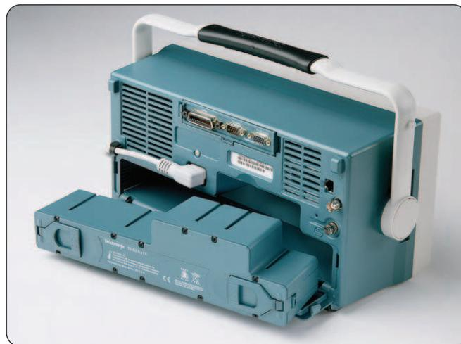
► TDS3BATC предоставляет возможность автономной работы от аккумулятора до трех часов.
