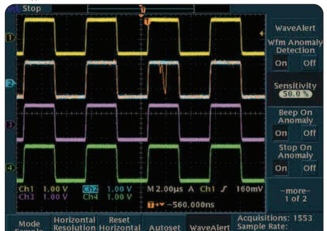
► Функция обнаружения аномалий осциллограммы WaveAlert оповещает обо всех осциллограммах, отличающихся от «нормального» вида, например о выбросе в канале 2.
