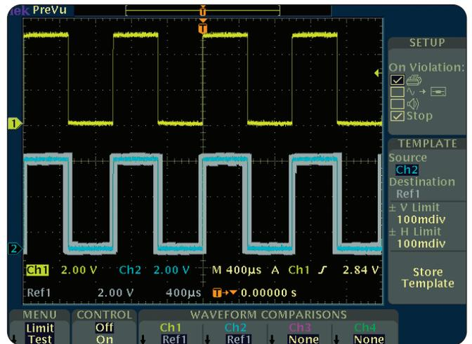
► Осциллограф с цифровым люминофором TDS3000C с модулем тестирования предельных значений TDS3LIM прекрасно подходит для производственных испытаний, когда требуется быстро принимать решения типа «годен/не годен».
