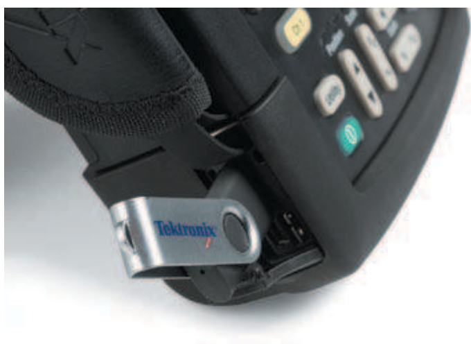
Стандартные порты USB позволяют использовать внешние накопители, передавать данные и управлять прибором.
